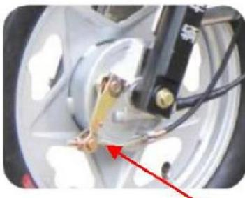
Расстояние, которое можно пройти зажимая рычаг до начала схватывания, называется игрой. Зазор не должен быть меньше половины величины сжатия, Если зазор неправильный. Если свободный ход неправильный, отрегулируйте его следующим образом.
