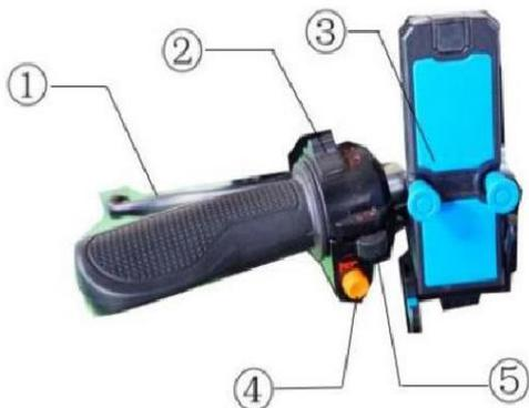
1. **Рычаг тормоза:** плавно зажимайте рычаг для комфортной остановки.
