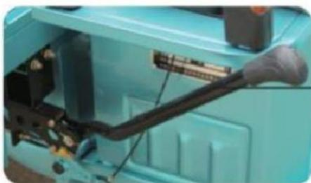
**Рычаг включения понижающей передачи.** Рабочая рукоятка находится в переднем рабочем положении, замедление задней оси небольшое, а скорость в это время высокая, что подходит для
