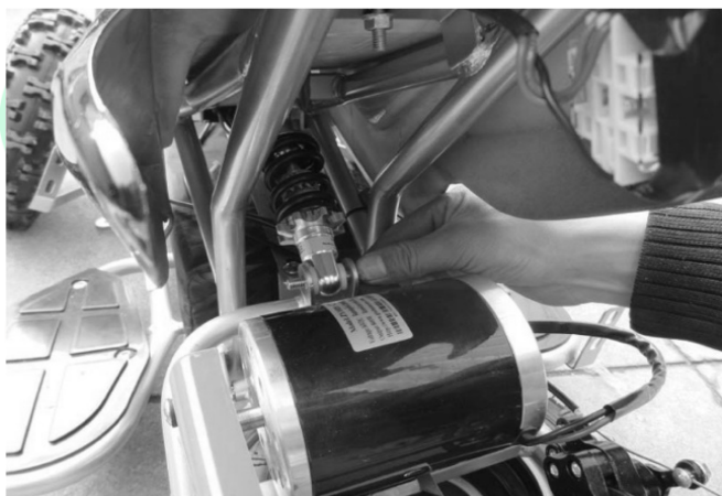
3. Установите задний амортизатор (Болт М8).
