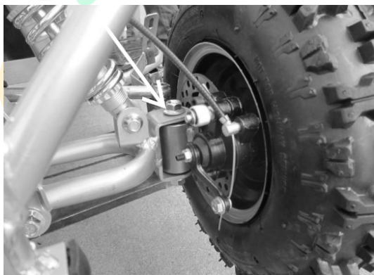
5. Установка передних колес: установите болт в дырки, затем зафиксируйте гайками.
