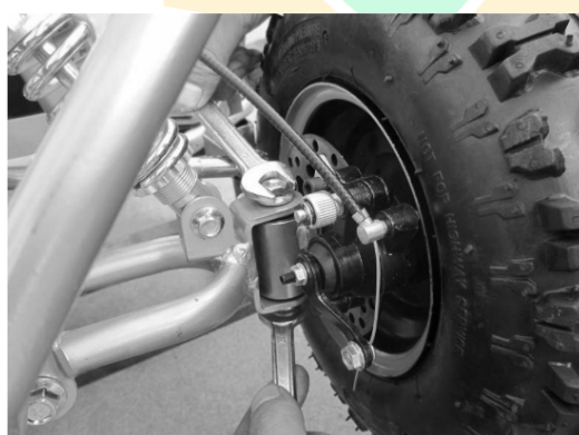
5. Установка передних колес: установите болт в дырки, затем зафиксируйте гайками.
